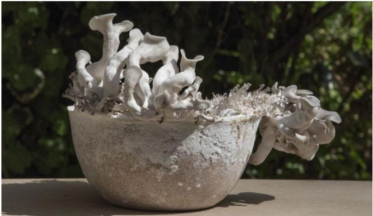
MOGU è una startup lombarda che ha trasformato il micelio dei funghi in un materiale per pavimenti, pannelli acustici e oggetti d'arredo. 100% biodegradabile, leggerissimo, resistente. Un'idea che coniuga bioeconomia, design e sostenibilità, oggi adottata da aziende italiane e internazionali.
