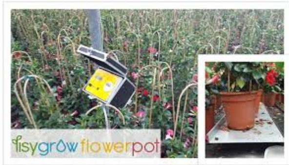
Un sistema di irrigazione automatizzato per coltivazioni fuori suolo, progettato per ottimizzare il consumo di risorse idriche ed energetiche e migliorare la produttività agricola. Utilizza la pianta stessa come sensore intelligente, regolando in tempo reale l'irrigazione in base al fabbisogno idrico effettivo, senza necessità di intervento manuale. La soluzione punta a ridurre lo spreco di risorse e aumentare la resa, contribuendo alla sostenibilità dell'agricoltura.
